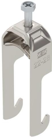
Bügelschelle mit W-Fuß, Metalldruckwanne mit gerundeten Kanten für Kabelschutz. Zur vertikalen und horizontalen Montage von 1 Einzelkabel an Winkelisen bis < 40 mm. Mit 1-gängiger Schraube an Druckwanne, universeller Sechskant-Schraubenkopf SW10, mit Schlitz und Kreuzschlitz. Geeignet für Montage im Innen- und Außenbereich. Der Einsatz einer Gegenwanne wird empfohlen.
