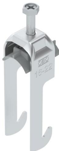
Bügelschelle mit W-Fuß, Kunststoffdruckwanne aus Polypropylen. Zur vertikalen und horizontalen Montage von 1 Einzelkabel an Winkeleisen bis < 40 mm. Mit 1-gängiger Schraube an Druckwanne, universeller Sechskant-Schraubkopf SW10, mit Schlitz und Kreuzschlitz. Geeignet für Montage im Innen- und Außenbereich. Der Einsatz einer Gegenwanne wird empfohlen.
