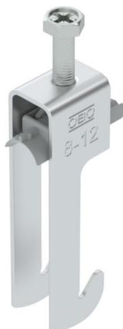
Bügelschelle mit W-Fuß, Kunststoffdruckwanne aus Polypropylen. Zur vertikalen und horizontalen Montage von 1 Einzelkabel an Winkeleisen bis < 40 mm. Mit 1-gängiger Schraube an Druckwanne, universeller Sechskant-Schraubkopf SW10, mit Schlitz und Kreuzschlitz. Geeignet für Montage im Innen- und Außenbereich. Der Einsatz einer Gegenwanne wird empfohlen.
