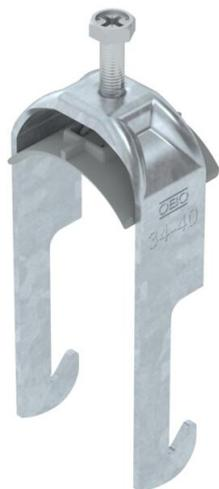
Bügelschelle mit W-Fuß, Kunststoffdruckwanne aus Polypropylen. Zur vertikalen und horizontalen Montage von 1 Einzelkabel an Winkeleisen bis < 40 mm. Mit 1-gängiger Schraube an Druckwanne, universeller Sechskant-Schraubenkopf SW10, mit Schlitz und Kreuzschlitz. Geeignet für Montage im Innen- und Außenbereich. Der Einsatz einer Gegenwanne wird empfohlen.
