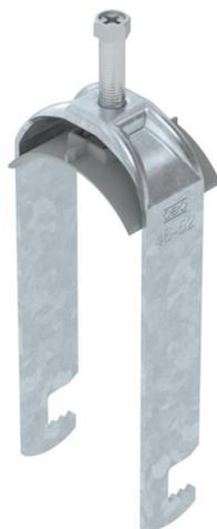
Bügel­schelle mit F-Fuß, Kunststoffdruckwanne aus Polypropylen. Zur vertikalen und horizontalen Montage von 2 Einzelkabeln an Flacheisen. Mit 1-gängiger Schraube an Druckwanne, universeller Sechskant-Schraubenkopf SW10, mit Schlitz und Kreuzschlitz. Geeignet für Montage im Innen- und Außenbereich. Mehrere Kabel sollten durch Doppelwannen getrennt werden. Der Einsatz einer Gegenwanne wird empfohlen.
