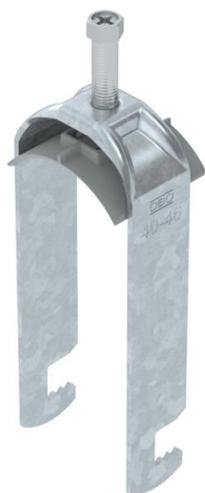
Bügelshelle mit F-Fuß, Kunststoffdruckwanne aus Polypropylen. Zur vertikalen und horizontalen Montage von 2 Einzelkabeln an Flacheisen. Mit 1-gängiger Schraube an Druckwanne, universeller Sechskant-Schraubenkopf SW10, mit Schlitz und Kreuzschlitz. Geeignet für Montage im Innen- und Außenbereich. Mehrere Kabel sollten durch Doppelwannen getrennt werden. Der Einsatz einer Gegenwanne wird empfohlen.
