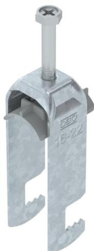
Bügel­schelle mit F-Fuß, Kunststoffdruckwanne aus Polypropylen. Zur vertikalen und horizontalen Montage von 2 Einzelkabeln an Flacheisen. Mit 1-gängiger Schraube an Druckwanne, universeller Sechskant-Schraubenkopf SW10, mit Schlitz und Kreuzschlitz. Geeignet für Montage im Innen- und Außenbereich. Mehrere Kabel sollten durch Doppelwannen getrennt werden. Der Einsatz einer Gegenwanne wird empfohlen.
