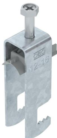
Bügel­schelle mit F-Fuß, Kunststoffdruckwanne aus Polypropylen. Zur vertikalen und horizontalen Montage von 2 Einzelkabeln an Flacheisen. Mit 1-gängiger Schraube an Druckwanne, universeller Sechskant-Schraubekopf SW10, mit Schlitz und Kreuzschlitz. Geeignet für Montage im Innen- und Außenbereich. Mehrere Kabel sollten durch Doppelwannen getrennt werden. Der Einsatz einer Gegenwanne wird empfohlen.
