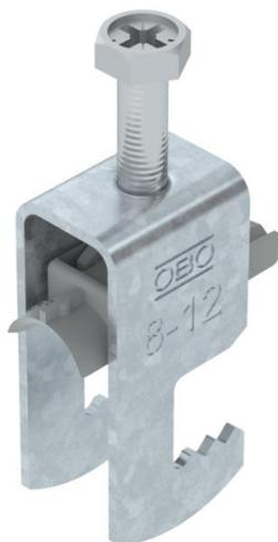
Bügelschelle mit F-Fuß, Kunststoffdruckwanne aus Polypropylen. Zur vertikalen und horizontalen Montage von 1 Einzelkabel an Flacheisen. Mit 1-gängiger Schraube an Druckwanne, universeller Sechskant-Schraubkopf SW10, mit Schlitz und Kreuzschlitz. Geeignet für Montage im Innen- und Außenbereich. Der Einsatz einer Gegenwanne wird empfohlen.
