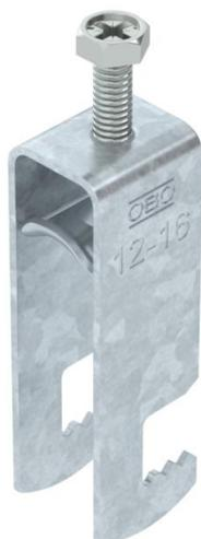
Bügel­schelle mit F-Fuß, Metall­druckwanne mit gerundeten Kanten für Kabel­schutz. Zur vertikalen und horizontalen Montage von 2 Einzelkabeln an Flacheisen. Mit 1-gängiger Schraube an Druckwanne, universeller Sechskant-Schraubenkopf SW10, mit Schlitz und Kreuzschlitz. Geeignet für Montage im Innen- und Außenbereich. Mehrere Kabel sollten durch Doppelwannen getrennt werden. Der Einsatz einer Gegenwanne wird empfohlen.
