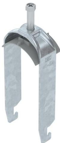
Bügelschelle mit U-Fuß, Kunststoffdruckwanne aus Polypropylen. Zur vertikalen und horizontalen Montage von 2 Einzelkabeln an C-Profilschiene. Für Schlitzweite 18 - 22 mm. Mit 1-gängiger Schraube an Druckwanne, universeller Sechskant-Schraubenkopf SW10, mit Schlitz und Kreuzschlitz. Geeignet für Montage im Innen- und Außenbereich. Mehrere Kabel sollten durch Doppelwannen getrennt werden. Der Einsatz einer Gegenwanne wird empfohlen.
