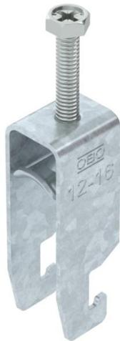
Bügelshelle mit U-Fuß, Metalldruckwanne mit gerundeten Kanten für Kabelschutz. Zur vertikalen und horizontalen Montage von 2 Einzelkabeln an C-Profilshiene. Für Schlitzweite 18 - 22 mm. Mit 1-gängiger Schraube an Druckwanne, universeller Sechskant-Schraubenkopf SW10, mit Schlitz und Kreuzschlitz. Geeignet für Montage im Innen- und Außenbereich. Mehrere Kabel sollten durch Doppelwannen getrennt werden. Der Einsatz einer Gegenwanne wird empfohlen.
