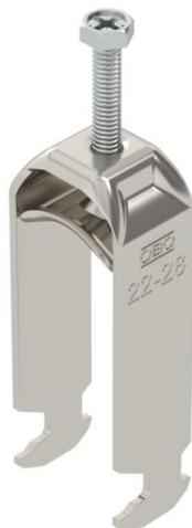
Bügelshelle mit Hammerkopf-Fuß, Metalldruckwanne mit gerundeten Kanten für Kabelschutz. Zur vertikalen und horizontalen Montage von 2 Einzelkabeln an C-Profileschiene. Für Schlitzweite 16 - 17 mm. Mit 1-gängiger Schraube an Druckwanne, universeller Sechskant-Schraubenkopf SW10, mit Schlitz und Kreuzschlitz. Geeignet für Montage im Innen- und Außenbereich. Mehrere Kabel sollten durch Doppelwannen getrennt werden. Der Einsatz einer Gegenwanne wird empfohlen.
