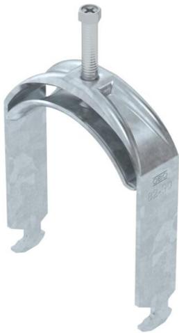
Bügelschelle mit Hammerkopf-Fuß, Metalldruckwanne mit gerundeten Kanten für Kabelschutz. Zur vertikalen und horizontalen Montage von 1 Einzelkabel an C-Profileschiene. Für Schlitzweite 16 - 17 mm. Mit 1-gängiger Schraube an Druckwanne, universeller Sechskant-Schraubenkopf SW10, mit Schlitz und Kreuzschlitz. Geeignet für Montage im Innen- und Außenbereich. Gegenwanne muss separat bestellt werden.
