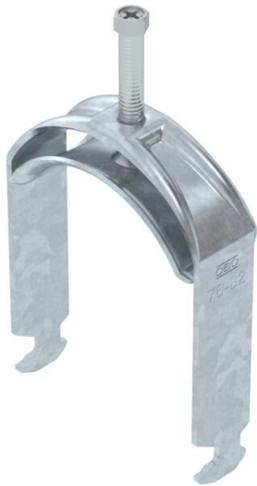
Bügelschelle mit Hammerkopf-Fuß, Metalldruckwanne mit gerundeten Kanten für Kabelschutz. Zur vertikalen und horizontalen Montage von 1 Einzelkabel an C-Profilschiene. Für Schlitzweite 16 - 17 mm. Mit 1-gängiger Schraube an Druckwanne, universeller Sechskant-Schraubenkopf SW10, mit Schlitz und Kreuzschlitz. Geeignet für Montage im Innen- und Außenbereich. Gegenwanne muss separat bestellt werden.
