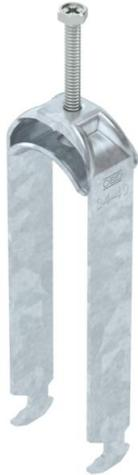
Bügelshelle mit Hammerkopf-Fuß, Metalldruckwanne mit gerundeten Kanten für Kabelschutz. Zur vertikalen und horizontalen Montage von 3 Einzelkabeln an C-Profilshiene. Für Schlitzweite 16 - 17 mm. Mit 1-gängiger Schraube an Druckwanne, universeller Sechskant-Schraubenkopf SW10, mit Schlitz und Kreuzschlitz. Geeignet für Montage im Innen- und Außenbereich. Mehrere Kabel sollten durch Doppelwannen getrennt werden. Der Einsatz einer Gegenwanne wird empfohlen.
