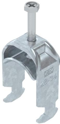
Bügelschelle mit Hammerkopf-Fuß, Metalldruckwanne mit gerundeten Kanten für Kabelschutz. Zur vertikalen und horizontalen Montage von 1 Einzelkabel an C-Profilschiene. Für Schlitzweite 16 - 17 mm. Mit 1-gängiger Schraube an Druckwanne, universeller Sechskant-Schraubenkopf SW10, mit Schlitz und Kreuzschlitz. Geeignet für Montage im Innen- und Außenbereich. Gegenwanne muss separat bestellt werden.
