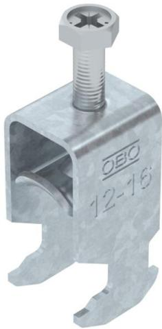
Bügelschelle mit Hammerkopf-Fuß, Metalldruckwanne mit gerundeten Kanten für Kabelschutz. Zur vertikalen und horizontalen Montage von 1 Einzelkabel an C-Profileschiene. Für Schlitzweite 16 - 17 mm. Mit 1-gängiger Schraube an Druckwanne, universeller Sechskant-Schraubenkopf SW10, mit Schlitz und Kreuzschlitz. Geeignet für Montage im Innen- und Außenbereich. Gegenwanne muss separat bestellt werden.
