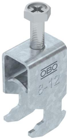
Bügelschelle mit Hammerkopf-Fuß, Metalldruckwanne mit gerundeten Kanten für Kabelschutz. Zur vertikalen und horizontalen Montage von 1 Einzelkabel an C-Profilschiene. Für Schlitzweite 16 - 17 mm. Mit 1-gängiger Schraube an Druckwanne, universeller Sechskant-Schraubenkopf SW10, mit Schlitz und Kreuzschlitz. Geeignet für Montage im Innen- und Außenbereich. Gegenwanne muss separat bestellt werden.
