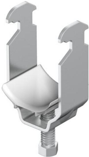
Passend zu allen C-Profilshienen mit 16 - 17 mm Schlitzweite; Schelle und Schraube aus Aluminium ALMg 3, Druckwanne aus Polypropylen, halogenfrei, lichtgrau RAL 7035.
