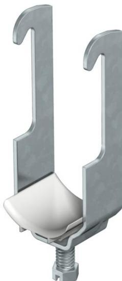
Passend zu Winkelleisen mit 40 mm Schenkellänge. Schelle und Schraube aus tauchfeuerverzinktem Stahl. Druckwanne aus Polypropylen, halogenfrei, Farbe Lichtgrau RAL 7035.
