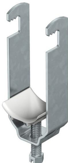
Passend zu Flach-, Winkel- und U-Eisen von 4 - 12 mm Materialstärke. Schelle und Schraube aus tauchfeuerverzinktem Stahl. Druckwanne aus Polypropylen, halogenfrei, Farbe Lichtgrau RAL 7035. Ausführung mit Anschweiß- und/oder Kontermutter für Einsatz unter erschwerten Bedingungen sowie für Rüttelsicherheit auf Anfrage!
