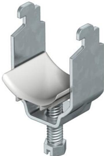
Passend zu allen C-Profileschienen mit 11 - 12 mm Schlitzweite, mindestens 6,5 mm lichter Innenhöhe und mindestens 18,5 mm lichter Innenbreite. Schelle und Schraube aus tauchfeuerverzinktem Stahl. Druckwanne aus Polypropylen, Farbe Lichtgrau RAL 7035, halogenfrei. Ausführung mit Anschweiß- und/oder Kontermutter für Einsatz unter erschwerten Bedingungen sowie für Rüttelsicherheit auf Anfrage!
