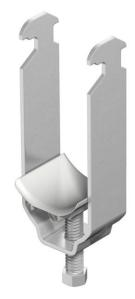
Passend zu allen C-Profilschienen mit 16 - 17 mm Schlitzweite; Schelle und Schraube aus Edelstahl rostfrei, Druckwanne aus Polypropylen, halogenfrei, lichtgrau RAL 7035.
