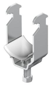
Passend zu allen C-Profilschienen mit 16 - 17 mm Schlitzweite. Schelle und Schraube aus Edelstahl. Druckwanne aus Polypropylen, halogenfrei, Farbe Lichtgrau RAL 7035.
