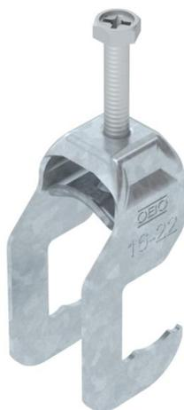
Bügelschelle mit RS-Fuß, Metalldruckwanne mit gerundeten Kanten für Kabelschutz. Zur vertikalen und horizontalen Montage von 1 Einzelkabel an Rundprofilen oder Rohren. Mit 1-gängiger Schraube an Druckwanne, universeller Sechskant-Schraubenkopf SW10, mit Schlitz und Kreuzschlitz. Passend zu allen Rundprofileisen bzw. Rohren mit Durchmesser bis 22 mm. Geeignet für Montage im Innen- und Außenbereich. Der Einsatz einer Gegenwanne wird empfohlen.
