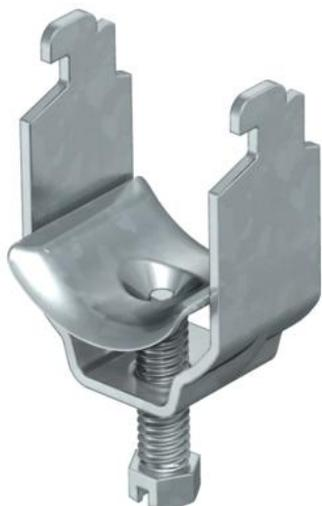
Passend zu allen C-Profileschienen mit 11 - 12 mm Schlitzweite; mindestens 6,5 mm lichter Innenhöhe und mindestens 18,5 mm lichter Innenbreite; Metallwannen haben allseitig stark gerundete Kanten, sodass keine Kabelbeschädigung zu befürchten ist. Ausführung mit Anschweiß- und/oder Kontermutter für Einsatz unter erschwerten Bedingungen sowie für Rüttelsicherheit auf Anfrage!
