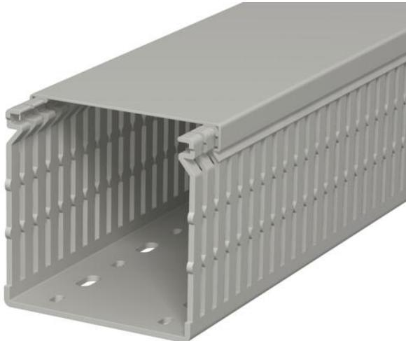
Verdrahtungskanal inkl. Oberteil und Bodenlochung zur waagerechten und senkrechten Verlegung elektrischer Kabel und Leitungen im Schaltschrank. Ausführung als metrischer Kanal. Das Nennmaß der Systemgröße entspricht dem Innenmaß der Kanäle. Das Ausbrechen der Stege erfolgt werkzeuglos. Bodenbündiges Ausführen ist durch Sollbruchstellen möglich. Verjüngungen in den Seitenschlitzen verhindern das Herausfallen der Leitungen. Geprüft nach DIN EN 50085-2-3. Sonderlängen auf Anfrage.
