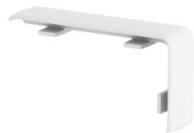
Stoßstellenabdeckung für das Unterteil der Geräteeinbaukanäle Rapid 45-2 zum Kaschieren von Schnittkanten und für eine einwandfreie Verbindung der Kanalsegmente. Die Stoßstellenabdeckungen werden aufgesteckt. Passend für die Kanalbreite 100 und 165 mm.
