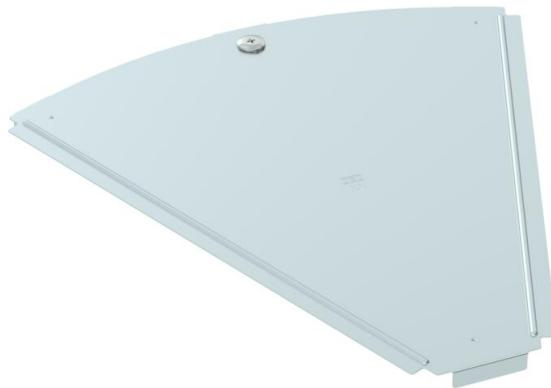
Deckel für Formteil Bogen 45° für rastbare und schraubbare Kabelrinnen im Innen- und Außenbereich, zum Schutz der Kabel vor Beschädigungen und Schmutz. Befestigung mit vormontiertem Drehriegel und durch Auflage des Streckendeckels. Passend für alle Seitenhöhen.
