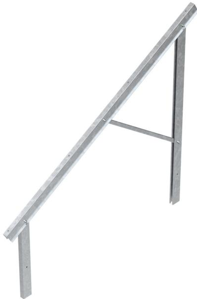
Vormontierter Träger in kleiner, mittlerer oder großer Ausführung zum Montieren von Photovoltaik-Freiflächensystemen in Kombination mit Trägerprofilen und End-/Zwischenklemmen. Montage mit Rammprofilen im Erdreich oder mit Standfüßen auf Betonfundamenten.
