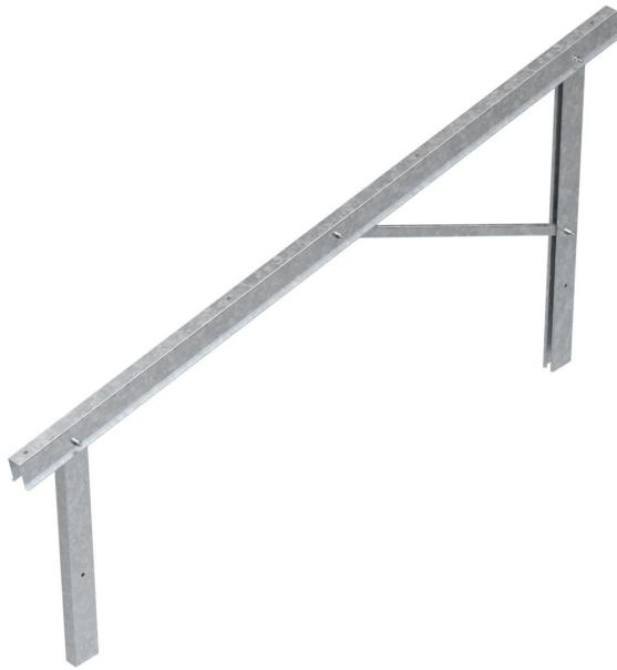
Vormontierter Träger in kleiner, mittlerer oder großer Ausführung zum Montieren von Photovoltaik-Freiflächensystemen in Kombination mit Trägerprofilen und End-/Zwischenklemmen. Montage mit Rammprofilen im Erdreich oder mit Standfüßen auf Betonfundamenten.
