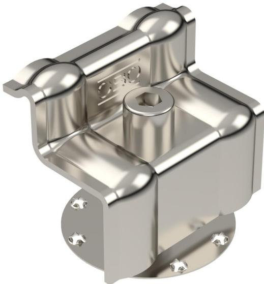
Endklemme mit Feder zum Befestigen von Photovoltaik-Modulen auf Trägerprofilen. Geeignet für Schlitzweite 10 mm. Schraubbare Befestigung des PV-Moduls mit Innensechskant-Schlüssel Größe 6.
