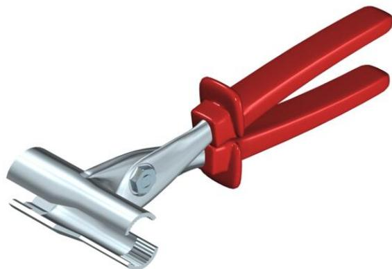
Universalwerkzeug zum mühelosen Festziehen aller Verschraubungen bis Größe PG 21 bzw. M25 x 1,5, auch anwendbar bei dicht nebeneinander angeordneten Verschraubungen. kleine Öffnung PG 7-PG 11 große Öffnung PG 13,5-PG 21
