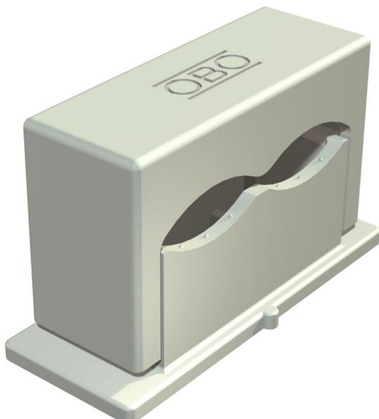
Für 2 Leitungen, mit Klebefuß, Langloch und zum Aufschrauben auf Gewinde M6. Zum Kleben der Polystyrol-Schellen auf Mauerwerk und Beton Impu-Fix-Stegleitungs-Schnellkleber Typ 509 verwenden.
