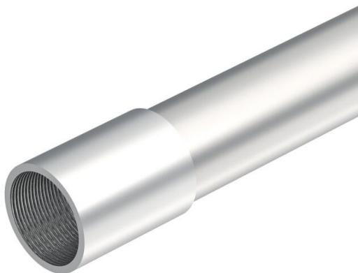
Elektroinstallationsrohr nach EN 61386-1, mit Gewindesteckern nach DIN EN 60423, für den mechanischen Schutz von Kabeln und Leitungen.
