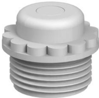
Mit Durchstoßmembrane, hierbei ist die Öffnung D vorgeprägt, aber zunächst verschlossen. Würgedichtung zum Einschrauben in PG-Gewinde nach DIN 40430. Mit selbstdichtendem Konus am Gewindeende, daher kein Anschlussgewindedichtring erforderlich. Erreichbare Schutzart bei sorgfältiger Montage IP54. Mit Durchstoßmembrane, hierbei ist die Öffnung D vorgeprägt, aber zunächst verschlossen.
