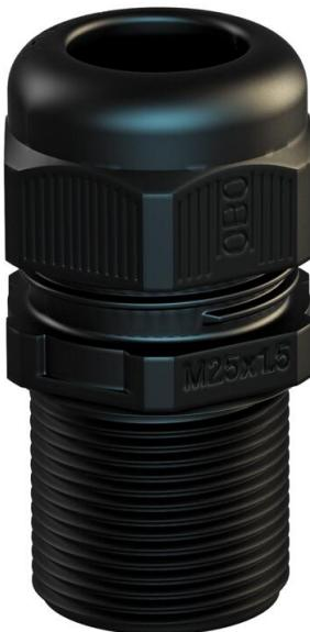
Kabelverschraubung mit metrischem Anschlussgewinde in Hutmutterbauart, für Kabelabzweigkästen, Gehäuse, Verteilerschränke im privaten und industriellen Bereich. Mit Zugentlastung und integrierter Dichtlippe, geprüft nach DIN EN 62444. Schutzklasse IP68. Einsetzbar von -20°C bis +65°C.
