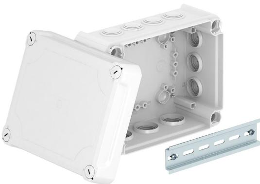
Kabelabzweigkasten zum Verbinden von Kabeln und Leitungen im Innenbereich und geschützten Außenbereichen. Rechteckige Form mit Einstechdichtungen an den Seiten und Ausschlägeöffnungen im Boden. Geeignet für die Wand-/ Deckenmontage und die Montage auf Montageblechen. Mit der Möglichkeit zur Innenbefestigung und Montage über die Eckdome. Hoher Deckel mit Schnellverschluss, plombierbar. Hergestellt aus halogenfreien und UV-resistenten Materialien.
