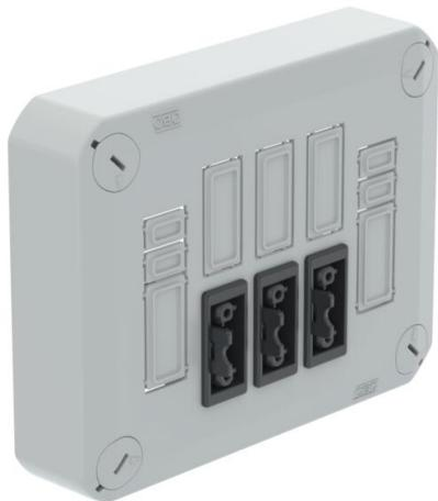
Steckbarer Deckel zum Verschließen von Kabelabzweigkästen, bestückt mit 3 Wieland GST18-Stecksystemen, vorverdrahtet mit Hebelsteckklemmen. Mit Schnellverschluss im Deckel, plombierbar. Halogenfreies Material, UV-resistent. Flammwidrig nach DIN EN 60695-2-11, Prüftemperatur 650°C. Schlagfestigkeit IK07 bei Raumtemperatur. Schutzart IP30.
