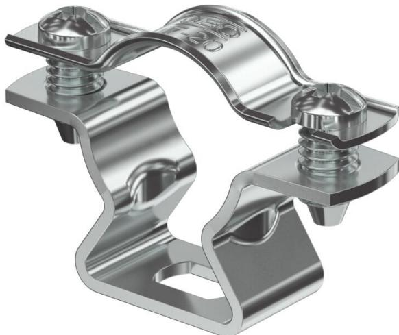
Abstandschelle zur Montage von Rohren und Kabeln an Wand, Decke und Boden. Mit selbstsicherndem Oberteil. Befestigung über Langloch. Ab der Schellengröße 20 geeignet für Montage mit Nagelgerät oder Bolzensetzgerät. Zugelassen für den Funktionserhalt nach DIN 4102 Teil 12, Funktionserhaltklassen E 30 bis E 90 (außer ALU).
