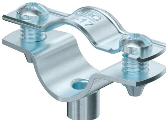
Abstandschelle zur Montage von Rohren und Kabeln an Wand, Decke und Boden. Mit selbstsicherndem Oberteil. Befestigung über Ansatz mit Innengewinde. Zugelassen für den Funktionserhalt nach DIN 4102 Teil 12, Funktionserhaltklassen E 30 bis E 90.
