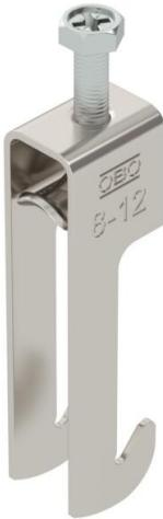
Bügelschelle mit W-Fuß, Metalldruckwanne mit gerundeten Kanten für Kabelschutz. Zur vertikalen und horizontalen Montage von 1 Einzelkabel an Winkeleisen mit 40 mm Schenkelänge. Mit 1-gängiger Schraube an Druckwanne, univer- seller Sechskant-Schraubenkopf SW10, mit Schlitz und Kreuzschlitz. Geeignet für Montage im Innen- und Außenbereich. Der Einsatz einer Gegenwanne wird empfohlen.
