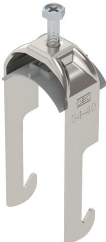
Bügelschelle mit W-Fuß, Kunststoffdruckwanne aus Polypropylen. Zur vertikalen und horizontalen Montage von 1 Einzelkabel an Winkelleisen mit 40 mm Schenkellänge. Mit 1-gängiger Schraube an Druckwanne, universeller Sechskantschraubekopf SW10, mit Schlitz und Kreuzschlitz. Geeignet für Montage im Innen- und Außenbereich. Der Einsatz einer Gegenwanne wird empfohlen.
