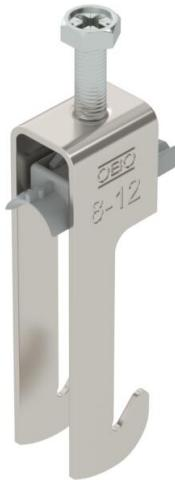
Bügelschelle mit W-Fuß, Kunststoffdruckwanne aus Polypropylen. Zur vertikalen und horizontalen Montage von 1 Einzelkabel an Winkelleisen mit 40 mm Schenkellänge. Mit 1-gängiger Schraube an Druckwanne, universeller Sechskantschraubekopf SW10, mit Schlitz und Kreuzschlitz. Geeignet für Montage im Innen- und Außenbereich. Der Einsatz einer Gegenwanne wird empfohlen.
