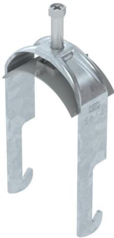
Bügelschelle mit W-Fuß, Kunststoffdruckwanne aus Polypropylen. Zur vertikalen und horizontalen Montage von 1 Einzelkabel an Winkelleisen mit 40 mm Schenkellänge. Mit 1-gängiger Schraube an Druckwanne, universeller Sechskantschraubenkopf SW10, mit Schlitz und Kreuzschlitz. Geeignet für Montage im Innen- und Außenbereich. Der Einsatz einer Gegenwanne wird empfohlen.
