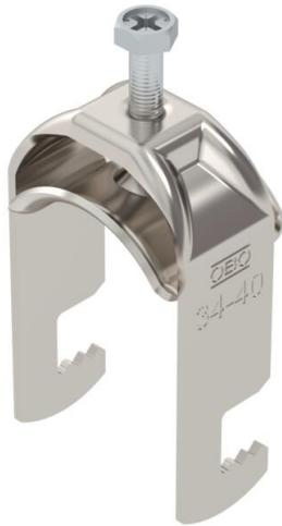
Bügelschelle mit F-Fuß, Metalldruckwanne mit gerundeten Kanten für Kabelschutz. Zur vertikalen und horizontalen Montage von 1 Einzelkabel an Flacheisen. Mit 1-gängiger Schraube an Druckwanne, universeller Sechskant-Schraubkopf SW10, mit Schlitz und Kreuzschlitz. Geeignet für Montage im Innen- und Außenbereich. Der Einsatz einer Gegenwanne wird empfohlen.
