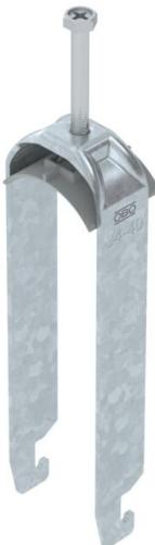
Bügelschelle mit U-Fuß, Kunststoffdruckwanne aus Polypropylen. Zur vertikalen und horizontalen Montage von 3 Einzelkabeln an C-Profilschiene. Für Schlitzweite 18 mm oder 22 mm. Mit 1-gängiger Schraube an Druckwanne, universeller Sechskant-Schraubenkopf SW10, mit Schlitz und Kreuzschlitz. Geeignet für Montage im Innen- und Außenbereich. Mehrere Kabel sollten durch Doppelwanne getrennt werden. Der Einsatz einer Gegenwanne wird empfohlen.
