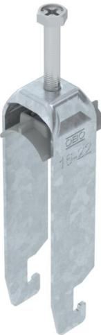
Bügelschelle mit U-Fuß, Kunststoffdruckwanne aus Polypropylen. Zur vertikalen und horizontalen Montage von 3 Einzelkabeln an C-Profilschiene. Für Schlitzweite 18 mm oder 22 mm. Mit 1-gängiger Schraube an Druckwanne, universeller Sechskant-Schraubenkopf SW10, mit Schlitz und Kreuzschlitz. Geeignet für Montage im Innen- und Außenbereich. Mehrere Kabel sollten durch Doppelwanne getrennt werden. Der Einsatz einer Gegenwanne wird empfohlen.
