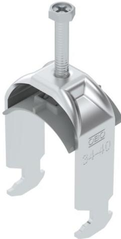
Bügelschelle mit Hammerkopf-Fuß, Kunststoffdruckwanne aus Polypropylen. Zur vertikalen und horizontalen Montage von 1 Einzelkabel an C-Proflischiene. Für Schlitzweite 16 - 17 mm. Mit 1-gängiger Schraube an Druckwanne, universeller Sechskant-Schraubenkopf SW10, mit Schlitz und Kreuzschlitz. Geeignet für Montage im Innen- und Außenbereich. Der Einsatz einer Gegenwanne wird empfohlen.
